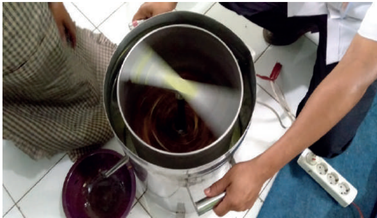
Gambar 24. Memisahkan minyak menggunakan spinner
